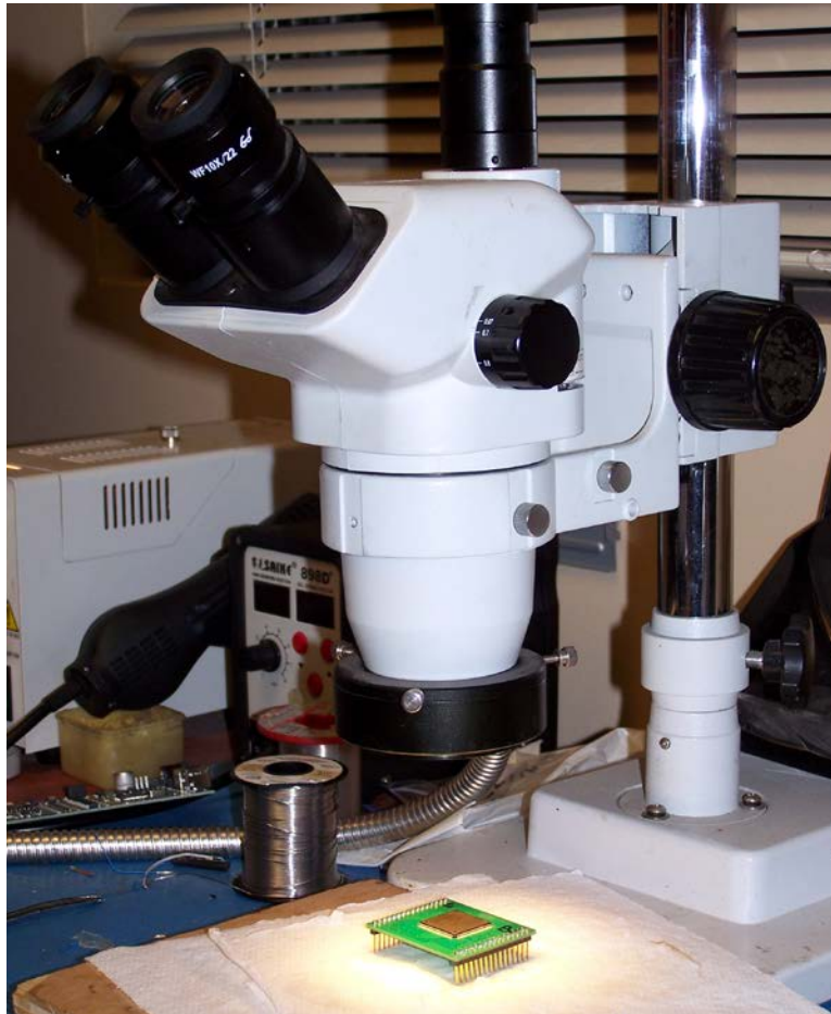
Figura 19. Utilizando el Microscopio de Inspección para controlar la calidad de la soldadura.
