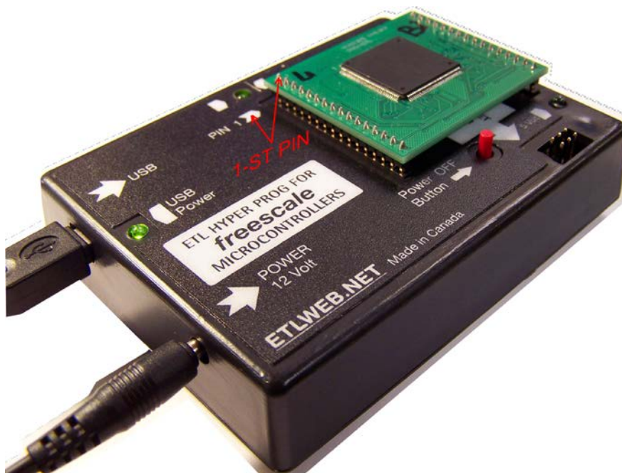
Figura 20. Inserción apropiada de la adaptación de la tarjeta.
